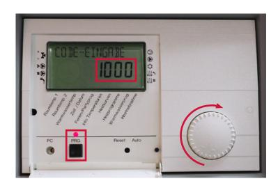
3. Im Display erscheint nun «0000», wobei die vordere «0» blinkt. Nun den Drehknopf nach rechts drehen, bis in der Anzeige an dieser Stelle eine «1» aufblinkt (Code 1000). Anschliessend drücken Sie viermal den PRG-Knopf.
