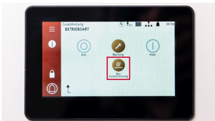
4. Um den «Notbetrieb» der Wärmepumpe zu aktivieren, drücken Sie auf den Button «Nur Zusatzheizung». Die beiden Buttons «Wartung» sowie «Nur Zusatzheizung» verfärben sich daraufhin orange.
