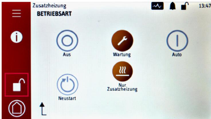
4. Nach Betätigung des Buttons und der Durchführung des Resets der Wärmepumpe wird der Button mit dem Glocken- und Haken-Symbol transparent angezeigt.
