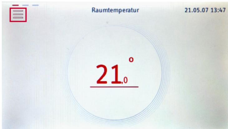
1. Um ins «Menü» der Wärmepumpe zu gelangen, drücken Sie oben links auf die drei Strichsymbole.
