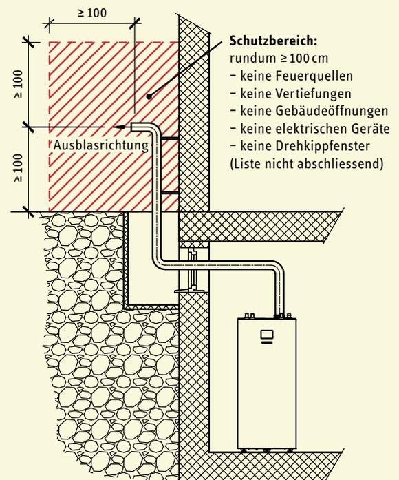
Erdsonden-Wärmepumpe WPE-I mit Entlüftungsvorkehrungen
