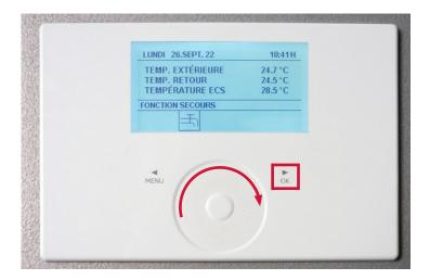
2. Tourner à droite sur l'anneau de commande, jusqu'à l'apparition de «FONCTION SECOURS». Cliquez ensuite sur «OK».
