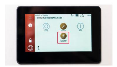
4. Pour activer le «fonctionnement d'urgence» de la pompe à chaleur, appuyez sur le bouton «Chauffage d'appoint...». Les deux boutons «Service» et «Chauffage d'appoint...» deviennent alors orange.
